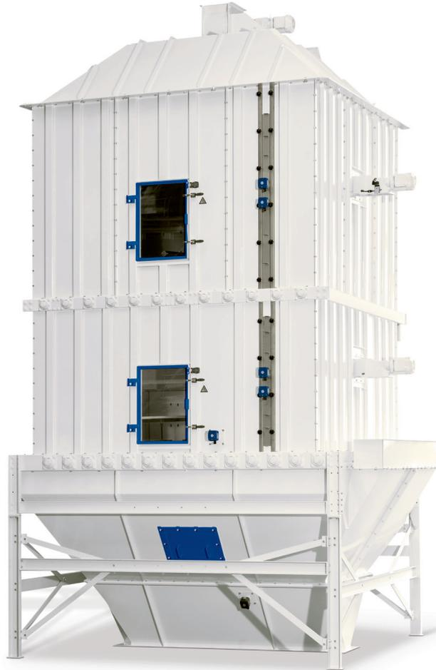
El refrigerador de piensos tipo harina a contracorriente se usa para la refrigeración de piensos triturados acondicionados mediante vapor hasta una temperatura cercana a la temperatura ambiente. El producto se refrigera mediante la aspiración de aire a través de una capa del producto.
