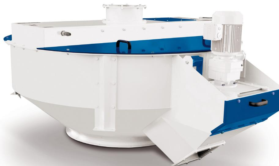
Трудно представить себе зерноперерабатывающую индустрию сыпучих продуктов без использования ротационного просеивателя Cryloc. В цилиндрическом корпусе одно или два сита специальной формы отделяют мелкие фракции от поступающего продукта. При максимум 10% мелких частиц на входе в результате получается не более 1% в конечном продукте (мелкие – это частицы менее 2\3 размера гранул).
